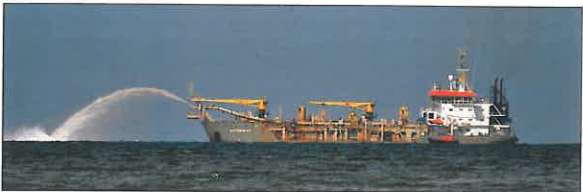
Abb. 41: Sandvorspülung im Rainbow-Verfahren. Wegen mangelnder Wassertiefe kann das Schiff seine Bodenluken nicht öffnen und pumpt das Sand-Wasser-Gemisch an die beabsichtigte Stelle (WIKIPEDIA.ORG-3 2010).
